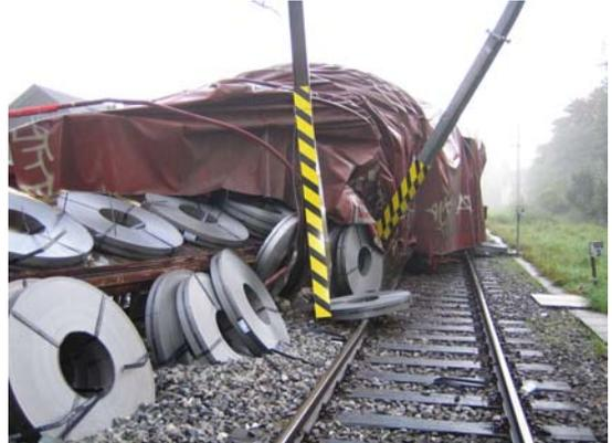
Der erste entgleiste Wagen des Typs Rils war mit Schmalbandcoils beladen.
