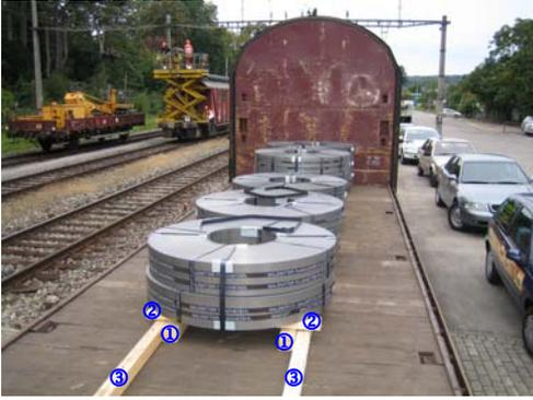
Die Schmalbandcoils werden mit zwei Stahlbändern an den Hölzern ② des Palettes festgemacht. Die übrigen Stahlbändern werden zur Sicherung des Bandes gegen das Aufrollen des benötigt.
