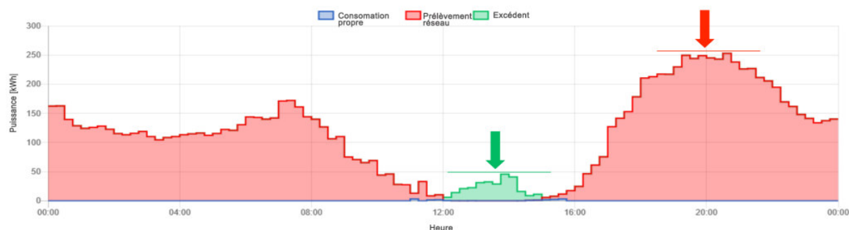
Figure 2 : courbe de charge à Erlenmatt-Ost un jour de mars. Une partie de l'électricité photovoltaïque qui n'est pas consommée l'après-midi est temporairement stockée dans les batteries des véhicules (flèche verte) et réinjectée le soir, ce qui réduit le soutirage sur le réseau externe (flèche rouge). Source : article spécialisé publié par l'OFEN 8
