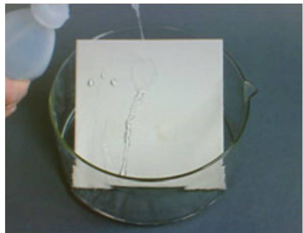
Figur 3: Beispiel des Einsatzes von Nano-Coatings. Oben: Benetzung einer unbeschichteten Steinplatte. Unten: Benetzung einer mit Nano-Coating beschichteten Steinplatte. Der wasserabstossende «Lotuseffekt» ist klar ersichtlich. Quelle: Zürcher Hochschule Winterthur.
