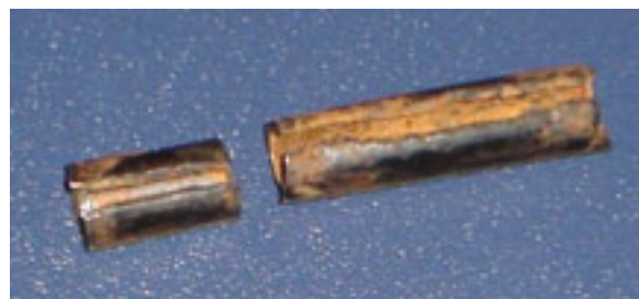
Figur 6: Qualität sichern ist besser als Heilen: Gebrochener Stift einer nicht normkonformen Druckrohrklappe. (Bild: Entec).
