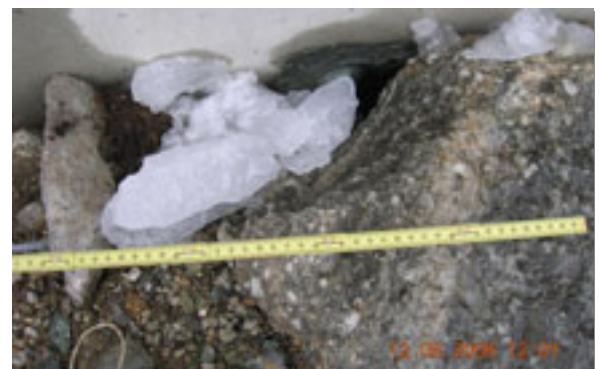
Figur 7: Eiswurf am Standort Gütsch, aufgenommen im Hochsommer (12.8.2006). Quelle: Meteotest.
