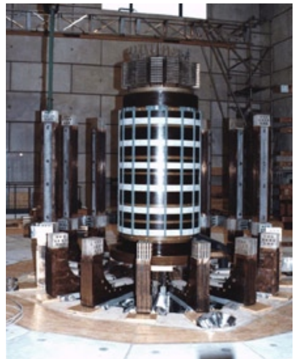
Figure 5 : la partie centrale du Tokamak à Configuration Variable (TCV) pendant la phase de construction ; on y voit clairement les parties inférieures des aimants pour les champs toroïdaux (TF). Photo : CRPP/EPFL.
