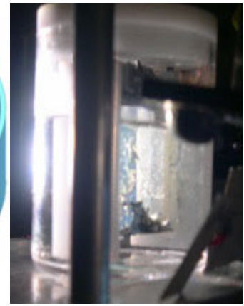
Figur 25: Tisch-Demonstratormodell zur photoelektrolytischen Wasserspaltung mittels Sonnenlicht ( WO_3 -Photoanode mit Pt-Kathode und Spannungserhöhung durch Si-Photovoltaikzelle – im Quarzglasbehälter mit 1M H_2SO_4 als Elektrolyt) [27].
