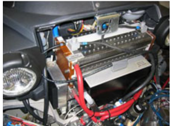
Figur 21: Übersicht über die Einbaupositionen des Staps im BZ-Fahrzeug SAM [20].
