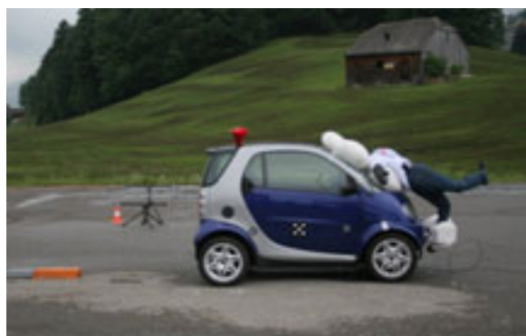
Figur 2: Erprobung des Crash mit einem Fussgänger: der Frontairbag mildert dessen Aufprall, die Fixation der Unterschenkel verhindern dessen Wegschleudern und damit dessen gefährlichen Zweitcrash (auf den Boden).
