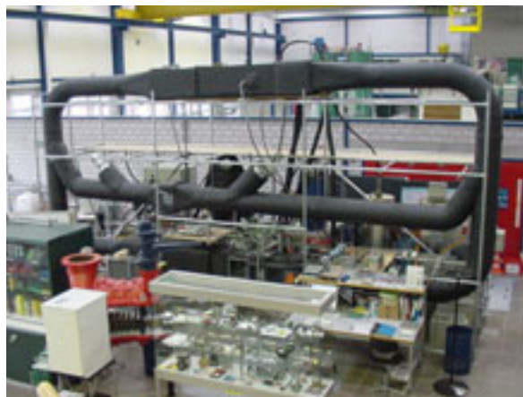
Figur 6: Versuchsanlage der HTA Luzern zur Untersuchung der Bereifungs- und Vereisungsproblematik an luftgekühlten Wärmetauschern.
