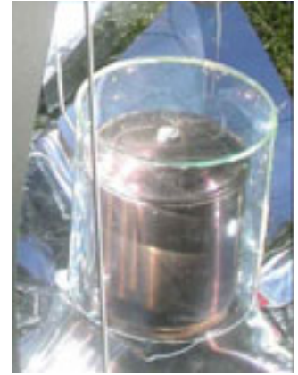
Figure 4 : le cuiseur solaire extra léger et pliable a été testé autour du monde. Illustration de gauche: test en camping dans le sud de l'Europe. Milieu: astuce de montage selon la hauteur du soleil. Droite: sélectivité de la casserole et couverture transparente pour une augmentation importante de la température. Source : Götz.
