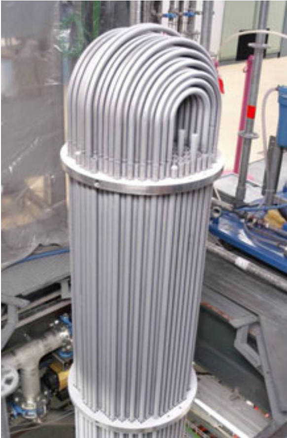
Figur 4: ARTIST Rohrbündel nach einem Aerosoltest. Die Rohre sind mit einer Schicht von Aerosolen belegt, die sich im Test abgelagert haben und somit im Bündelbereich zurückgehalten wurden (Quelle: PSI).
