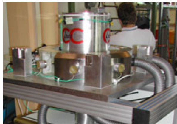
Figur 5: Prototyp einer magnetokalorischen Kältemaschine, welcher auf der Weltausstellung in Hannover ausgestellt wurde.
