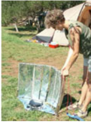
Figure 4 : le cuiseur solaire extra léger et pliable a été testé autour du monde. Illustration de gauche: test en camping dans le sud de l'Europe. Milieu: astuce de montage selon la hauteur du soleil. Droite: sélectivité de la casserole et couverture transparente pour une augmentation importante de la température. Source : Götz.
