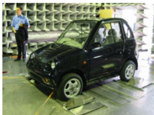
Figur 5: Der REVA Euro zum Nachweis der EMV-Verträglichkeit auf dem Rollenprüfstand.
