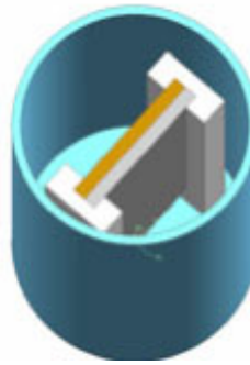
Figur 25: Tisch-Demonstratormodell zur photoelektrolytischen Wasserspaltung mittels Sonnenlicht ( WO_3 -Photoanode mit Pt-Kathode und Spannungserhöhung durch Si-Photovoltaikzelle – im Quarzglasbehälter mit 1M H_2SO_4 als Elektrolyt) [27].
