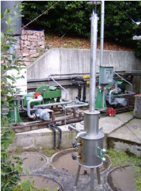
Figur 4: Fackel im Versuchsbetrieb auf einer kantonalen Deponie im Kanton Tessin.
