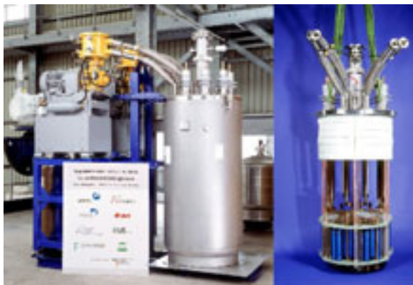
Figur 1: Ein 10 MVA-HTSL-Strombegrenzer (Siemens).
