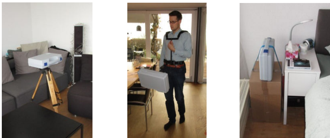
Figura 3: Rappresentazione della configurazione di misura per "spot-local" (sinistra), "spot-area" (centro) e "spot-24h" (destra)
