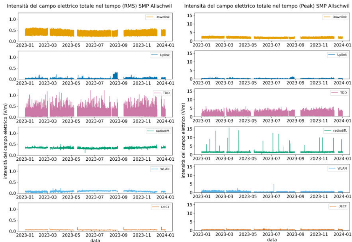
Figura 48: Curva di intensità del campo elettrico delle misure continue per l'anno 2023 presso il sito TPH di Allschwil, raggruppate per categoria di sorgente. La parte sinistra del grafico mostra i valori RMS, mentre i corrispondenti valori di picco sono mostrati nella parte destra.
