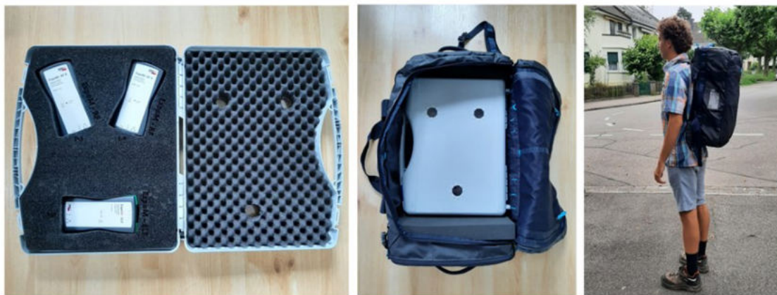
Figura 2: Illustrazione della configurazione per la misurazione del percorso. A sinistra: Tre dispositivi di misurazione (due ExpoM-RF4 e un ExpoM-ELF) sono fissati in una valigia riempita di schiuma. Al centro: la valigetta viene inserita nello zaino e fissata con la schiuma. A destra: il soggetto in esame indossa lo zaino con i dispositivi di misurazione a una distanza di 20 cm dal corpo e a un'altezza di 160 cm.
