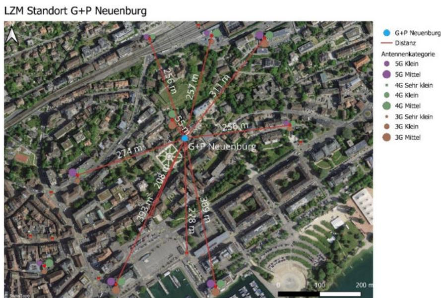
Abbildung 43: Mobilfunkantennenstandorte in der näheren Umgebung der Dauermessstation in Neuenburg, klassiert nach Mobilfunkstandard und Sendeleistung [21]. Die roten Distanzlinien sind als kürzeste horizontale Abstände zwischen der Antenne und dem Feldstärkesensor aufzufassen. Höhenunterschiede werden nicht berücksichtigt. Da keine Informationen über die azimutale Ausrichtung der Antennensektoren vorliegen, ist eine Beitragsabschätzung einzelner Antennen unmöglich.
