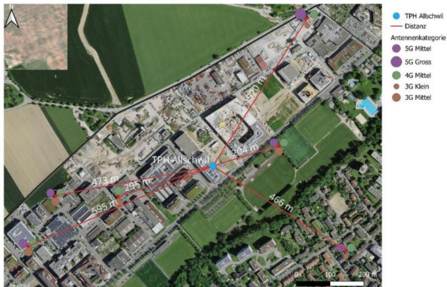
Abbildung 46: Mobilfunkantennenstandorte in der näheren Umgebung der Dauermessstation in Allschwil, klassiert nach Mobilfunkstandard und Sendeleistung [21]. Die roten Distanzlinien sind als kürzeste horizontale Abstände zwischen der Antenne und dem Feldstärkesensor aufzufassen. Höhenunterschiede werden nicht berücksichtigt. Da keine Informationen über die azimutale Ausrichtung der Antennensektoren vorliegen, ist eine Beitragsabschätzung einzelner Antennen unmöglich.
