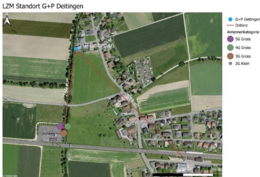
Abbildung 44: Mobilfunkantennenstandorte in der näheren Umgebung der Dauermessstation in Deitingen, klassiert nach Mobilfunkstandard und Sendeleistung [21]. Die roten Distanzlinien sind als kürzeste horizontale Abstände zwischen der Antenne und dem Feldstärkesensor aufzufassen. Höhenunterschiede werden nicht berücksichtigt. Da keine Informationen über die azimutale Ausrichtung der Antennensektoren vorliegen, ist eine Beitragsabschätzung einzelner Antennen unmöglich.
