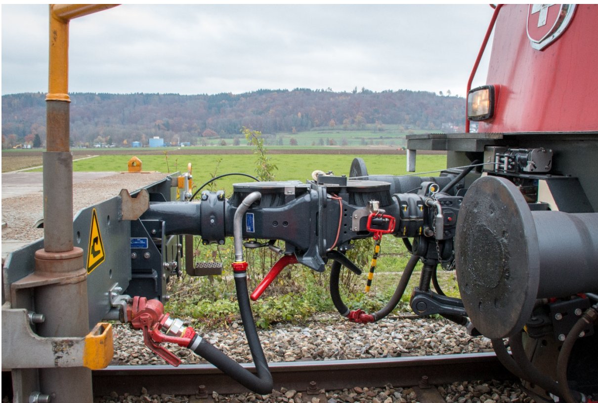
L'accoppiamento automatico digitale (DAC) su un treno di prova della FFS.
