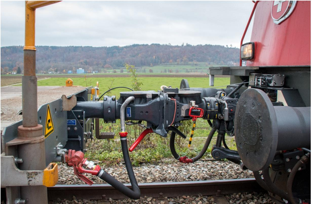
*L'attelage automatique numérique (DAC) sur un train d'essai des CFF.*
