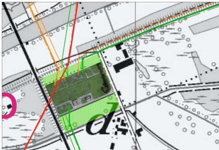
Figura 23: SS Magadino odierna (rosso: linea 380 kV, verde: linee 220 kV e arancione 150kV)
