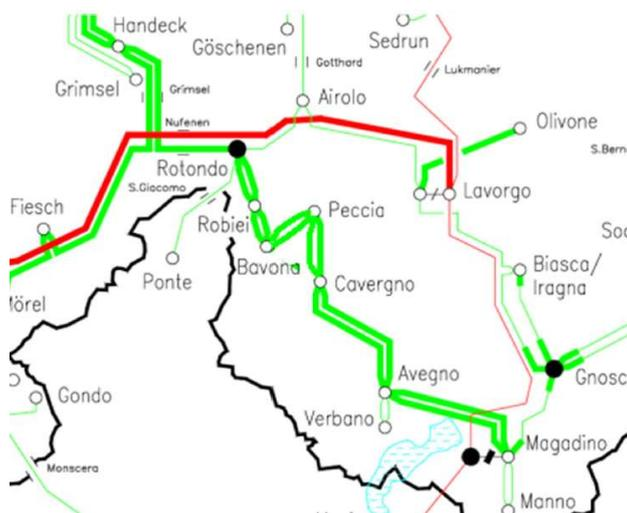
Figura 9: Schema di rete futura con doppio collegamento tra Bavona e Peccia ed attraverso la Val Lavizzara fino a Caveragno (in verde le linee a 220 kV e in rosso a 380 kV)
