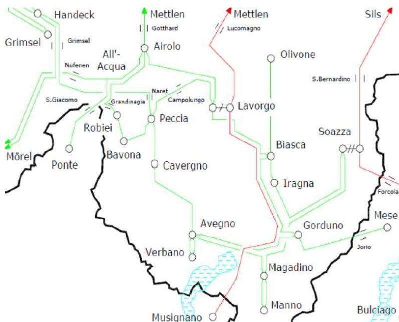
Figura 17: schema di rete attuale; in verde le linee 220 kV e in rosso le 380 kV
