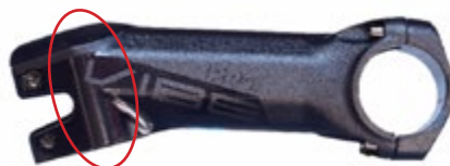
Figura 2: Le crepe possono verificarsi nell'area di serraggio del tubo sterzo della forcella.
