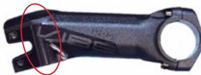
Abbildung 2: Bildung von Rissen im Klemmbereich des Steuerrohrs.
