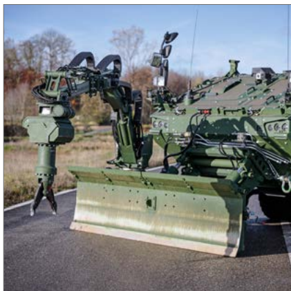
Piranha IV con lama di sgombero e braccio prensile
