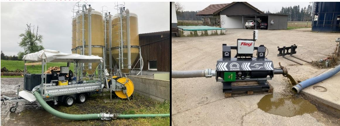
Die von Agroscope finanzierte mobile Güllemessstation ist mit einem NIR-Sensor (Nahinfrarot) ausgestattet. Damit lässt sich die Zusammensetzung der Gülle präzise und in Echtzeit feststellen – und damit auch, was auf dem Feld ausgebracht wird.
