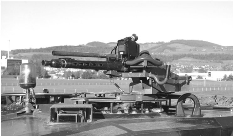
Mitrailleuse en tourelle avec dispositif optique de visée
