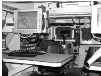
Véhicule de commandement SIC (chasseur de chars 90, PIRANHA I, 6x6, transformé)
