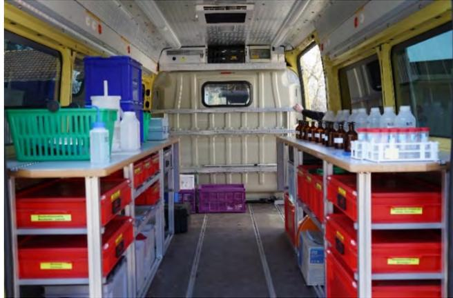
Illustration 9 : Préparation mobile des échantillons dans le bus du laboratoire de Spiez
