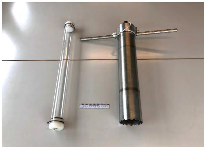
Dans la zone principale, la profondeur de pénétration praticable des tubes en plastique était de 60 cm. Le substrat du sol était toutefois plus dense à proximité du rivage, de sorte que les échantillons ont dû être prélevés au moyen de la « foreuse à couronne ». Le type d'appareils de prélèvement utilisés ainsi que la taille des échantillons ont été consignés (voir l'annexe 8.6).
