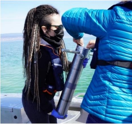
Abbildung 8: Sedimentprobe im Kronenbohrer
