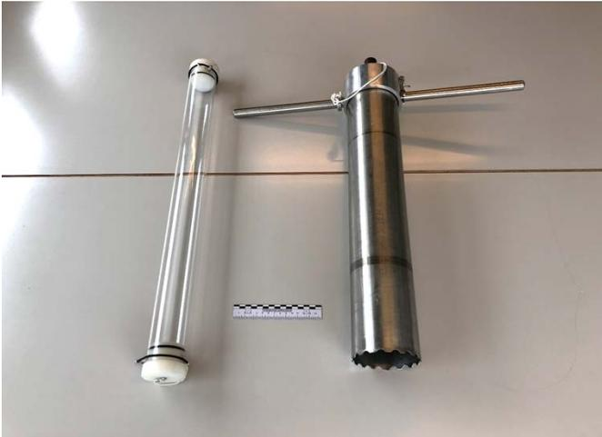
Im Hauptfeld lag die praktikable Eindringtiefe der Kunststoffrohre bei 60 cm. Näher zum Ufer hin ist das Bodensubstrat jedoch zunehmend fester und die Proben mussten hier mittels "Kronenbohrer" entnommen werden. Die Art der verwendeten Entnahmegereäte sowie die erreichte Probenhöhe wurden protokolliert (siehe Anhang 8.6).
