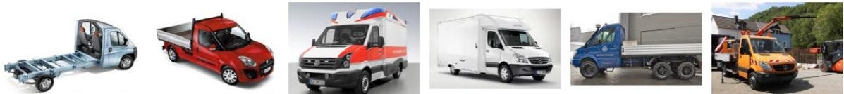
Abbildung 24: Verschiedene Arten von mehrstufigen leichten Nutzfahrzeugen<sup>10</sup>
