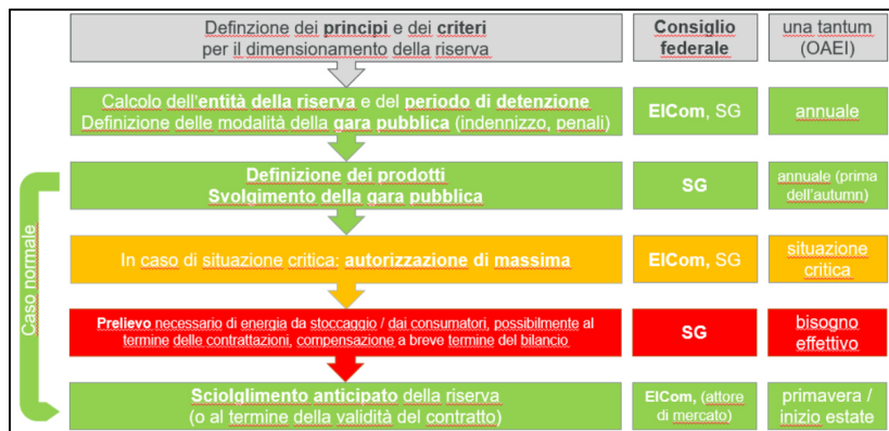
Figura 2: le principali fasi del processo, i responsabili e la frequenza delle fasi per la riserva di stoccaggio (SG = Swissgrid). I principali responsabili sono contrassegnati in grassetto, le altre parti direttamente interessate in carattere normale. Spiegazione dei colori: grigio = fase preparatoria che si svolge una sola volta; verde = fase che normalmente si svolge ogni anno; giallo = fase che si svolge soltanto se si delinea, ma non si è ancora verificata, una situazione critica per l'approvvigionamento; rosso = fase di prelievo dell'energia di riserva, qualora si verifichi effettivamente una situazione di carenza.
