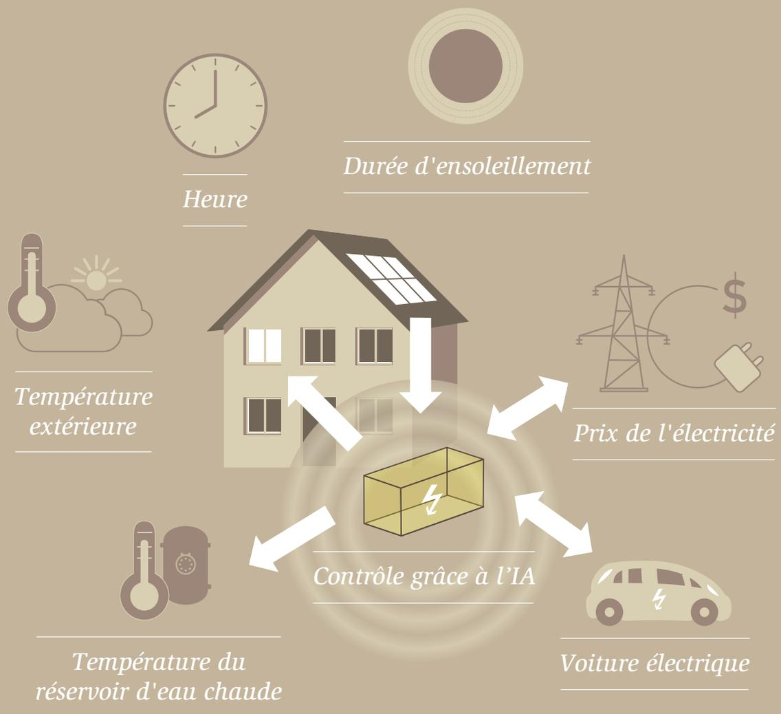
*Le système de contrôle intelligent de l'Empa distribue l'électricité des capteurs solaires de manière optimale. Il n'a pas besoin d'être programmé, mais « apprend » les besoins des occupants grâce à l'intelligence artificielle et s'adapte au moment de la journée et aux saisons. Il peut être utilisé pour des bâtiments de différents types et de différentes tailles.*
