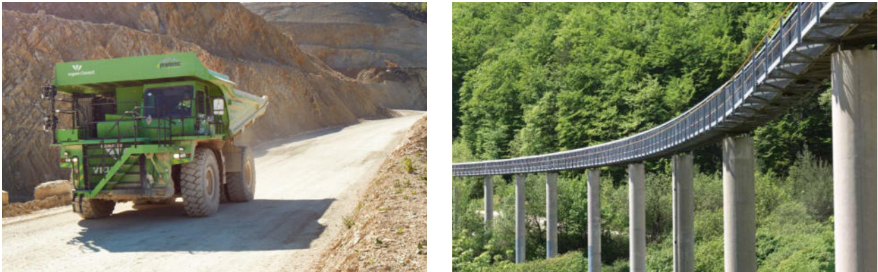
Fig. 13: Elektrisch betriebener Dumper (links) und Förderband (rechts) beim Zementwerk in Péry. Bildquelle: Vigier Ciment SA.
