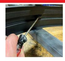
2B: Schrauben Sie die mittige Schutzblechschraube mit einem 4-mm-Inbusschlüssel heraus (Sie können die Schraube entsorgen – es wird eine neue Schraube bereitgestellt).
