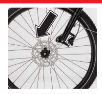
4B: Führen Sie die Steckachse auf der linken Seite in das Gabel-Ausfallende ein und schieben Sie diese durch die Laufradnabe.
