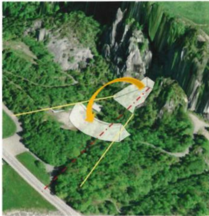
Abbildung 9: schichtweiser Abtrag Felssturzmaterial und sukzessives Freilegen Lastwagenzugang Süd (aus Variantenblatt "B.1 Einschnitt Süd" aus Projektphase I)
