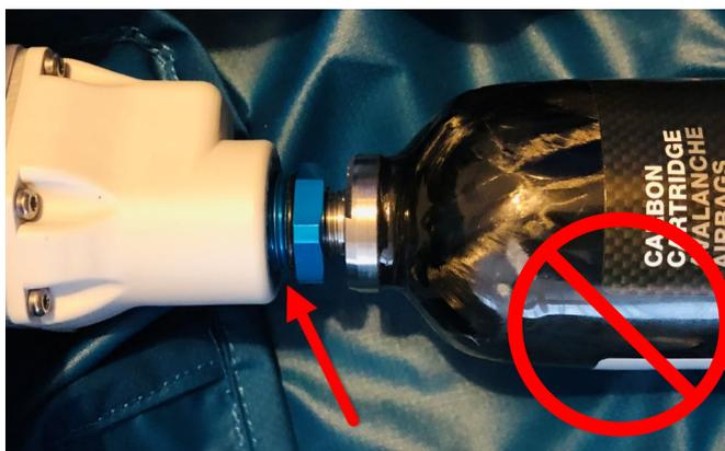
Illustration : mauvaise installation de la cartouche dans le mécanisme de l'Airbag Inflation System (le joint en caoutchouc noir est encore visible).
