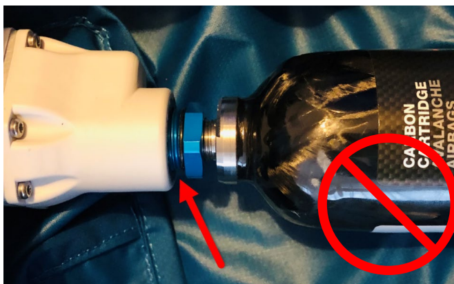
Abbildung: NICHT korrekt montierte Kartusche im Mechanismus des Airbag Inflation-System – schwarze Gummidichtung ist sichtbar
