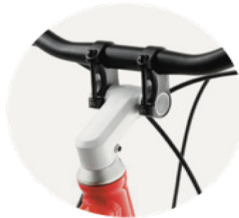
Vario-Vorbau am woom 4, 5 und 6 • Vario stem on woom 4, 5 and 6 Attacco manubrio Vario per woom 4, 5 e 6 • Potence Vario sur les woom 4, 5 et 6
