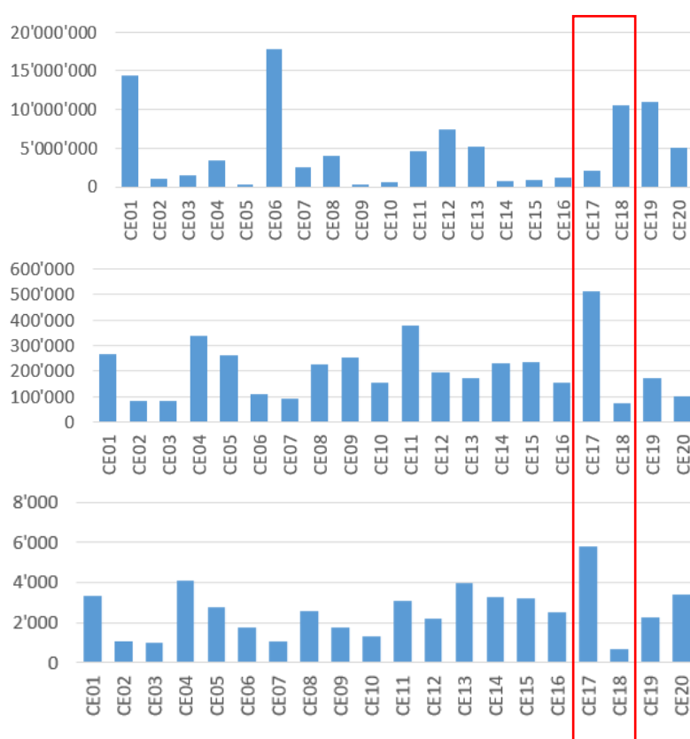
Graphique 31 : Frais d'assainissement en CHF par bâtiment, logement et m 2 de surface utile principale
