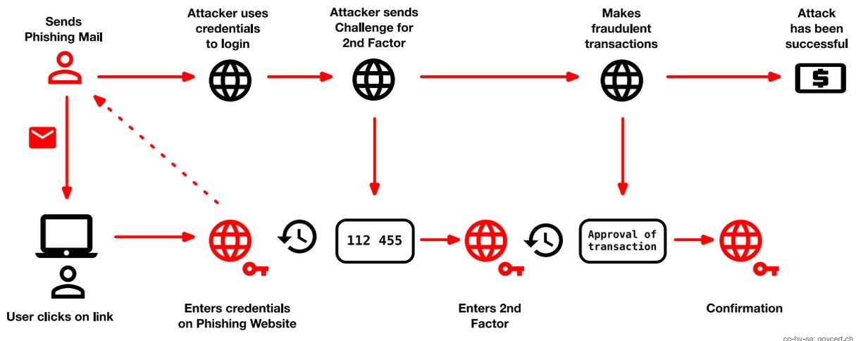
Abbildung 3: Ablaufschema eines Real Time Phishing Angriffs
