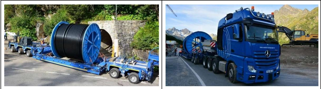
**Abbildung 7: Transportfahrzeug mit Kabeltrommel auf Spezialplattform, Achse in Fahrtrichtung transportiert (Quelle: Fa. Wassermann Kabeltechnik)**
