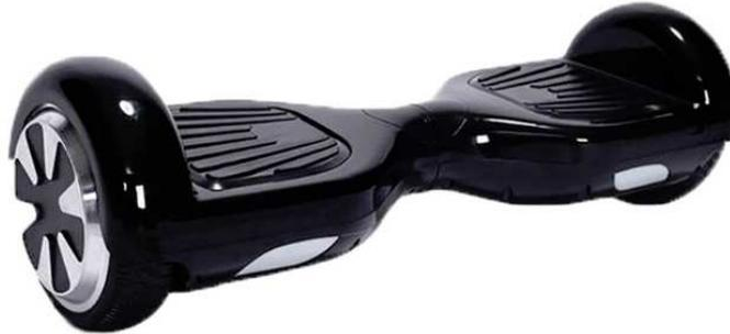
Dal 2017, gli Hoverboard elettrici sono dotati di un BMS (Battery Management System). Questo sistema previene il sovraccarico e il surriscaldamento della batteria. Gli hoverboard dotati di questo sistema hanno un numero di serie che inizia con 16047..... o superiore.
