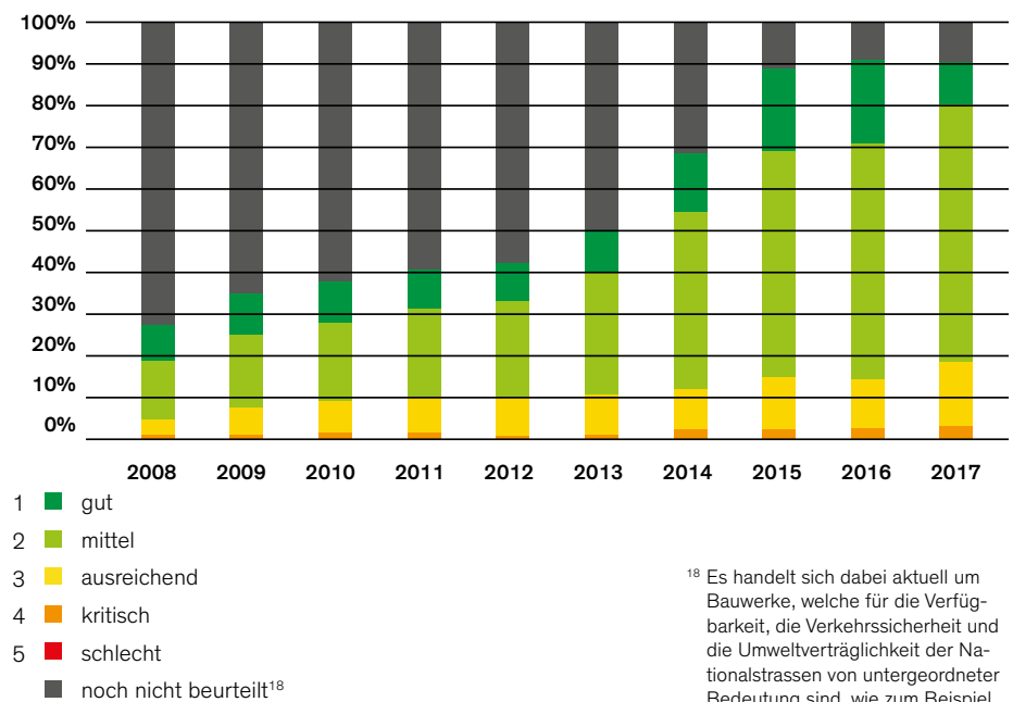
Mittlere Zustandswerte der Tunnel und Untertagebauten
