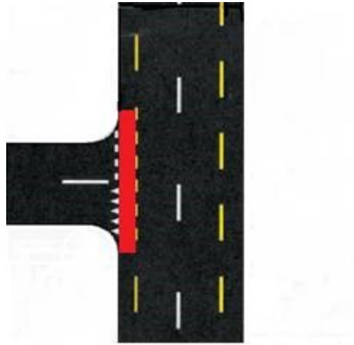
Fig. 6 Esempio di applicazione della demarcazione «colorazione rossa delle corsie ciclabili»
