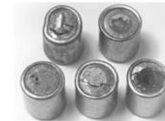
Risse Abdeckfolie durch Korrosion
