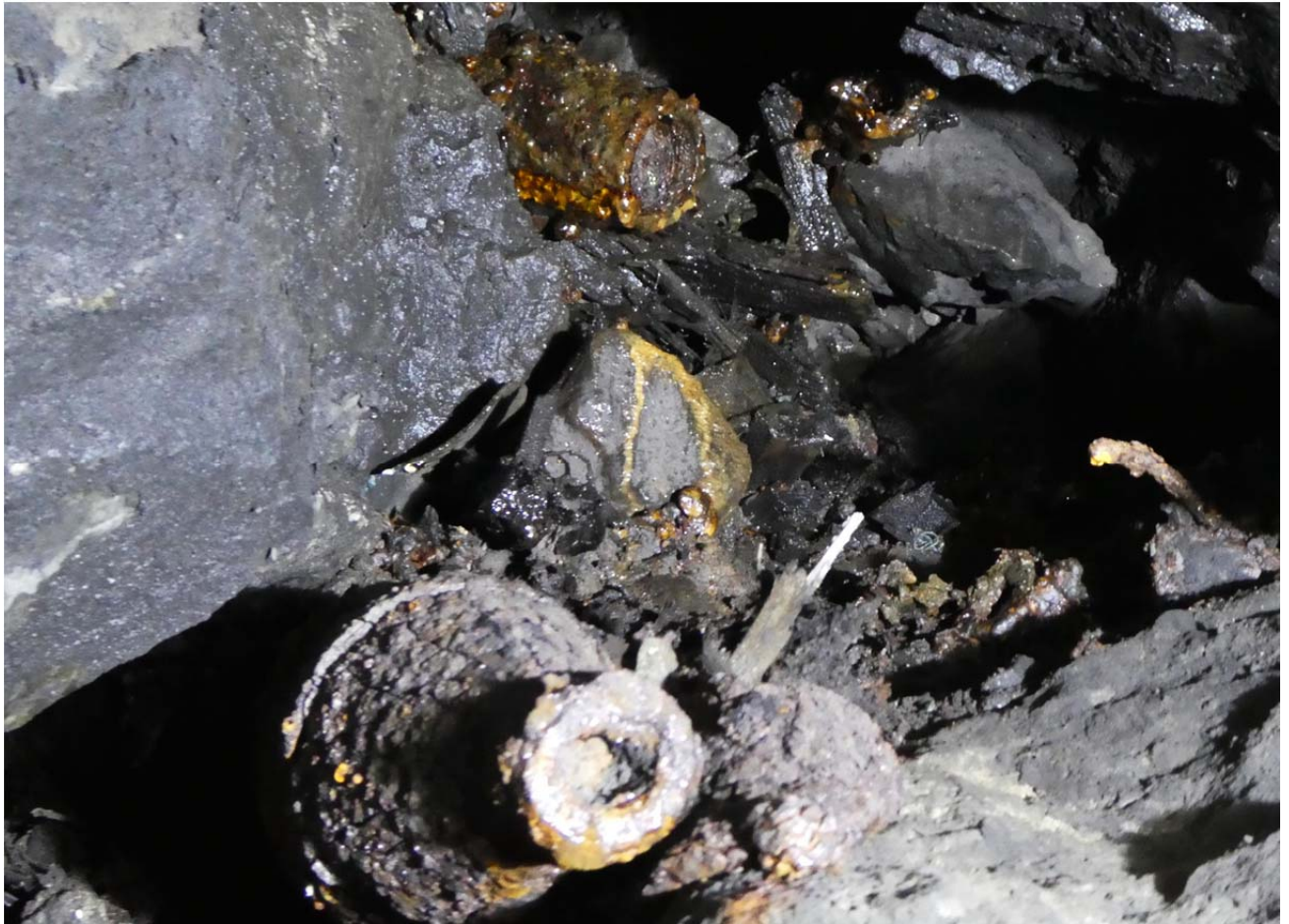
Abbildung 7: Beispiele von korrodiertem Munition
