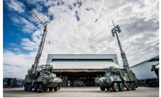
Avec le système intégré d'exploration et d'émission radio (IFASS), l'armée dispose d'un système qui lui permet d'explorer le trafic radio, d'en localiser les sources et, si nécessaire, de les brouiller. En cas d'urgence, le système IFASS peut aussi servir à diffuser des informations à la population.
