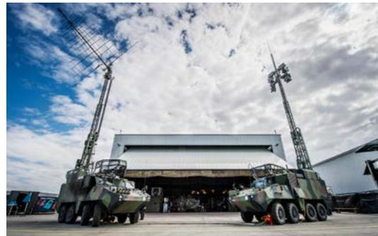
Die Armee verfügt mit dem Integrierten Funkaufklärungs- und Sendesystem (IFASS) über ein System, das es ermöglicht, Funkaktivitäten aufzuklären, ihre Quellen zu orten und sie im Bedarfsfall zu stören. In Notlagen kann das System IFASS auch zur Ausstrahlung von Informationen für die Bevölkerung eingesetzt werden.
