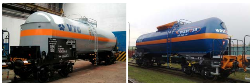
Abbildung 7: Crash Protected Rail Tank Car (CPR II) der VTG und "Safe Tank Car" der Wascosa
