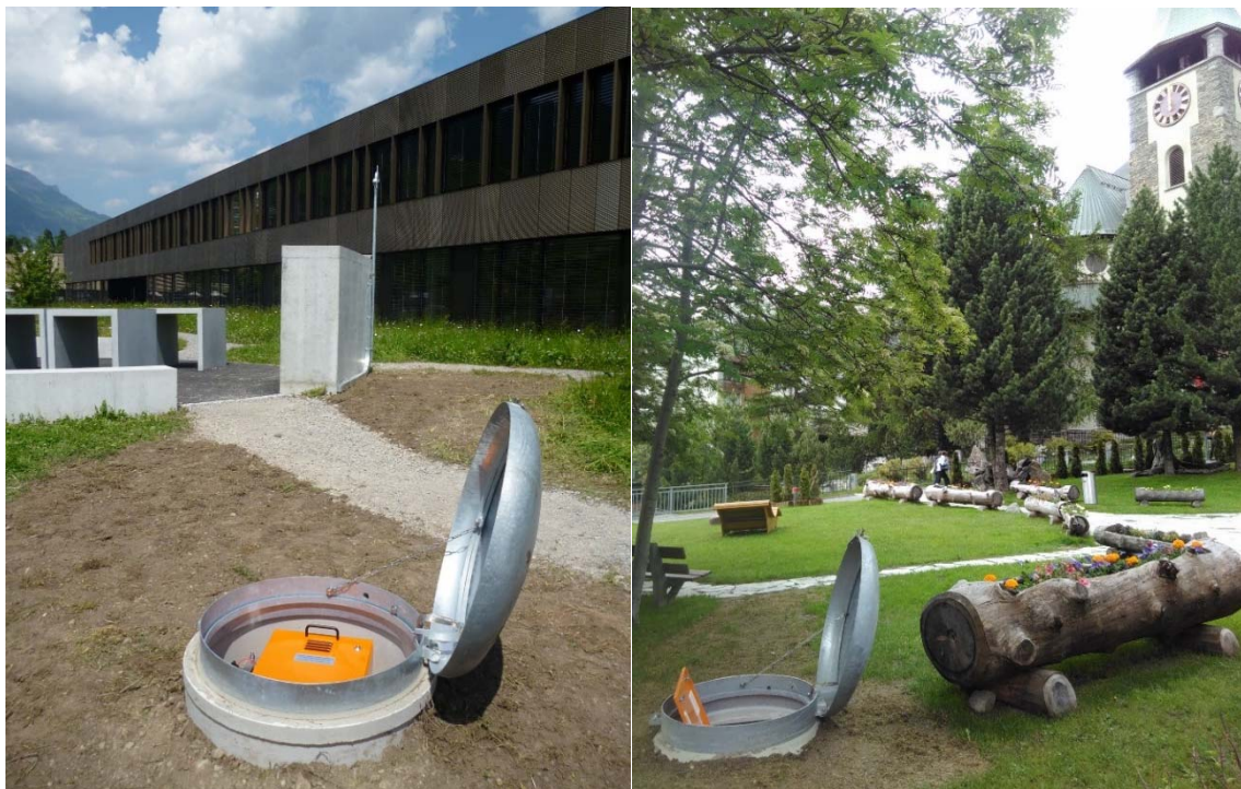
Abbildung 3: Typische Standorte von Starkbebenstationen im Erneuerungsprojekt. Die Installation ist im Boden versenkt und nur am Schachtdeckel erkennbar: Kantonsschule in Sarnen (links), Zentrum von Zermatt (rechts).
