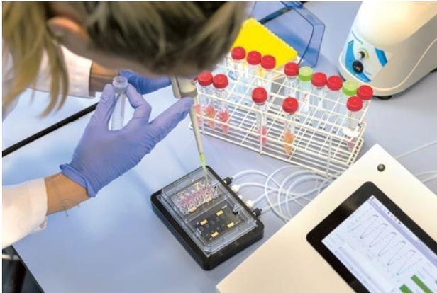
auf der die Zellen kultiviert werden. Auf der einen Seite der Membran sind die angesiedelten Zellen der Luft ausgesetzt, auf der anderen einem Nährmedium, das dem Blut entspricht. Über ein Mikrozwerchfell lassen sich die Zellen im Atemrhythmus dehnen, über dünne Schläuche wird Luft zugeführt.
