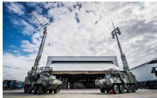
Avec le système intégré d'exploration et d'émission radio (IFASS), l'armée dispose d'un système qui lui permet d'explorer le trafic radio, d'en localiser les sources et, si nécessaire, de les brouiller. En cas d'urgence, le système IFASS peut aussi servir à diffuser des informations à la population.
