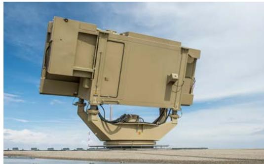
Pour surveiller l'espace aérien, assurer la sécurité de la navigation aérienne militaire et la conduite centralisée des engagements, les Forces aériennes ont besoin d'une image de la situation aérienne qui leur est fournie principalement par des stations radar (capteurs) et des centres de calcul. Le système de surveillance de l'espace aérien et de conduite des opérations aériennes FLORAKO avait été acheté dans ce but avec les programmes d'armement 1998/1999.
