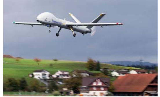
ADS 15 ist ein unbemanntes und unbewaffnetes Aufklärungssystem. Es soll das gegenwärtig in der Armee eingesetzte Aufklärungsdrohnensystem 95 ersetzen, das dem Technologiestand der achtziger Jahre entspricht. Die vorgesehene Nutzungsdauer von ADS 15 beträgt 20 Jahre.
