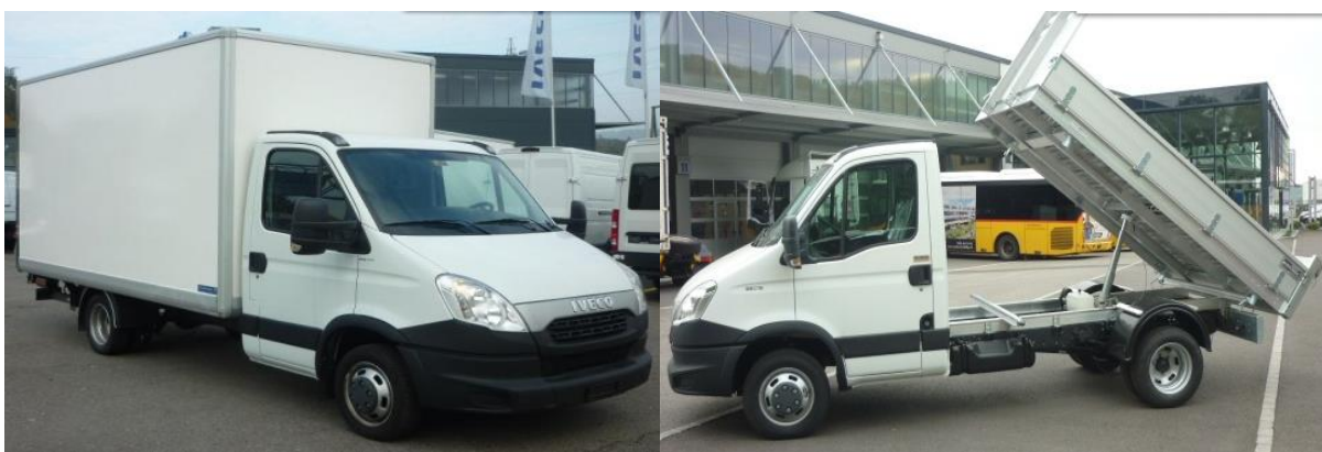
Iveco Daily mit Kastenaufbau Nutzlast: 800 kg
