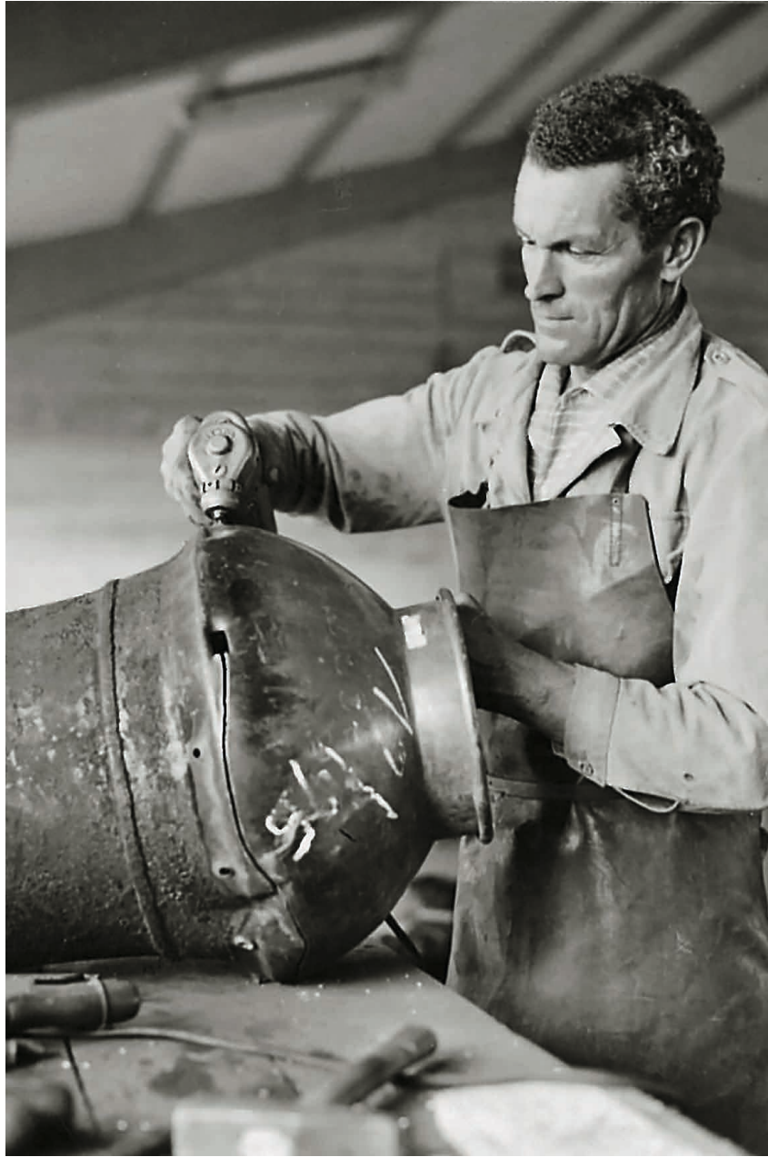
3.3.4 Les alambics rachetés sont acheminés par rail à l'entrepôt de Romanshorn, où ils sont démontés.
