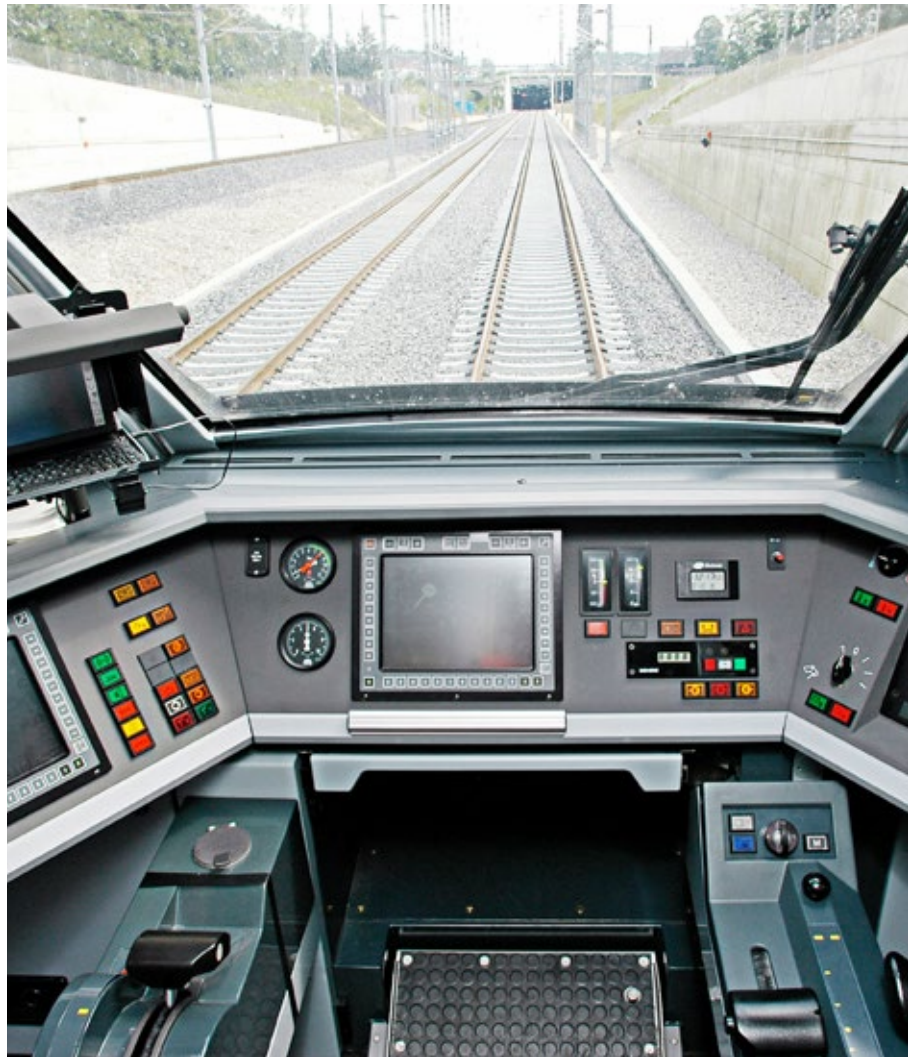
Die Modernisierung der Zugbeeinflussung (ETCS-Technologie) erhöht die Sicherheit im Bahnverkehr.
