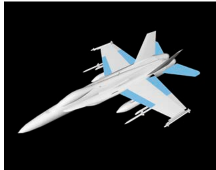
Les différentes gouvernes du F/A-18 (voilet de bord d'attaque intérieur, voilet de bord de fuite, stabilisateur horizontal)
