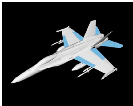
F/A-18 mit hervorgehobenen Flugsteuerflächen (Eintrittsklappe, Austrittsklappe und horizontaler Stabilisator)
