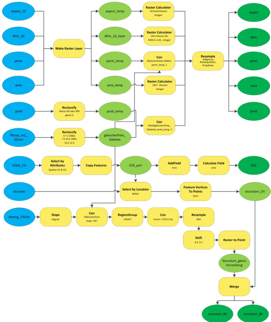
Abbildung 3 Übersicht Pre-Processing Steinschlag
