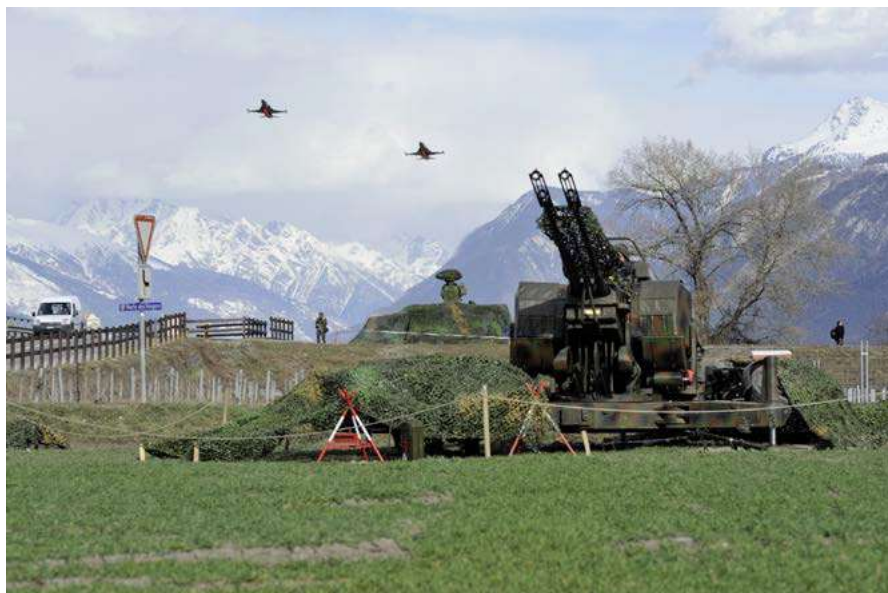
DCA di calibro medio: dispositivo con radar (sensore) e cannone (effettore)
