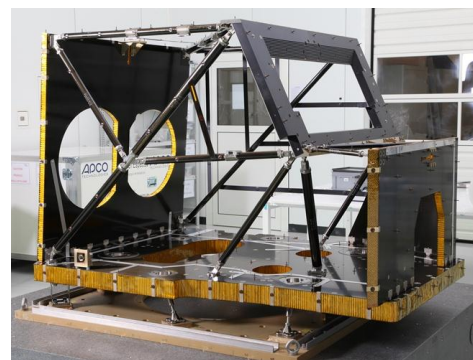
Structure porteuse de la caméra multispectrale (MSI) de Sentinel-2A durant son élaboration ©APCO
