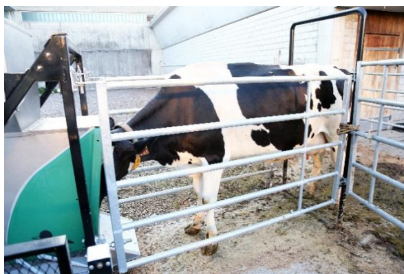
Neue Messmethode von Treibhausgasen bei Rindern mit dem Green-Feed-System ® . (Bilder: Agroscope)
