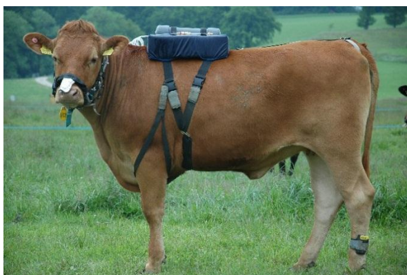
Probensammlung für die Schwefel-Hexafluorid (SF 6 )-Markermethode, eine der bisherigen Methoden zur Messung von Treibhausgasen beim Rind.
