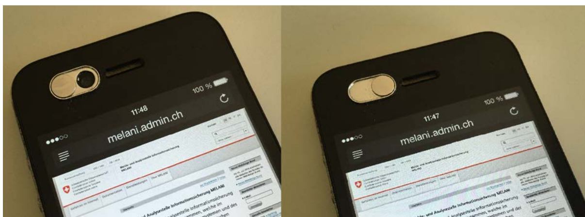
Fig. 5: Cache webcam coulissant en position ouverte (à gauche) et fermée. 8
