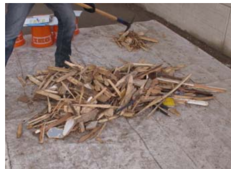
Fig. 5: Frazionamento con la pala
